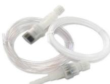
TOUS les DLX sont fournis avec un kit d'installation PVDF-FPM standard, composé d'un tube de décharge en PE de 2 m (4x6 mm), d'une aspiration de 2 m + d'un tube en cristal de PVC à saignement de 2 m (4x6 mm), d'un filtre à pied en PVDF, d'une valve d'injection en PVDF. D'autres configurations sont disponibles sur demande.
